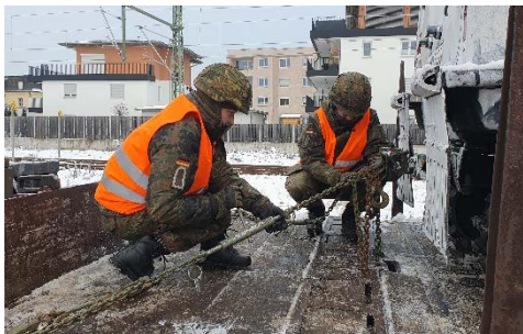
Mit routinierten Handgriffen werden die Überschnee-Fahrzeuge für den langen Transportweg gesichert. Foto: Gebirgsjägerbrigade 23 / Weich.
